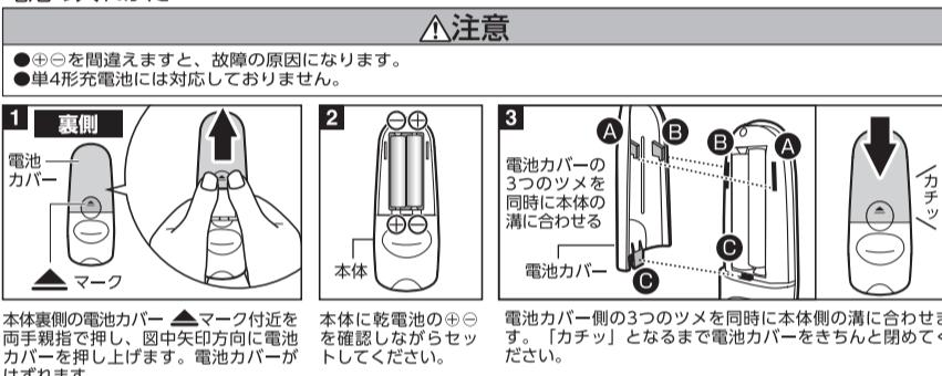
本体裏側の電池カバー ▲マーク付近を両手親指で押し、図中矢印方向に電池カバーを押し上げます。電池カバーがはずれます。
