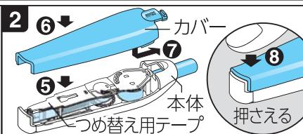
※先端が出たままでは交換できません。**①ノック**して先端を戻した状態にしてから、**②“OPEN”部**を押さえて、**③矢印方向へスライドさせて、カバーを取り外します。****④使い終わった“つめ替え用テープ”を取り外します。**本体にのりが付いている時は、セロテープなどでひつづけて除去します。
