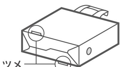
④底面のツメを内側から押して溝に差し込みます。
