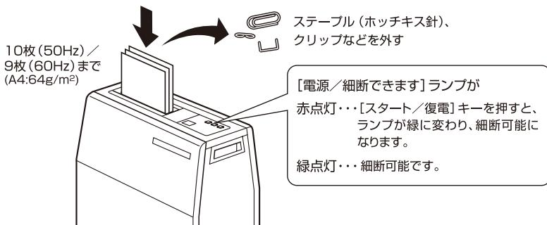
\*投入口センサーが10秒間紙を検知しないと、オートスタート機能を解除します。また、何も操作をしないで5分間たつと、細断できなくなります（省電力モード）。細断を再開するには[スタート／復電]キーを押してください。
