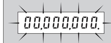
電源スイッチを“OFF”にして再び“ON”にします。次に1桁目の“0”を確認後、(P)を押します。
