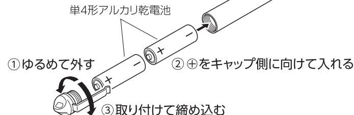
③ 電池キャップを①と逆の方向に回して取り付けてください。
