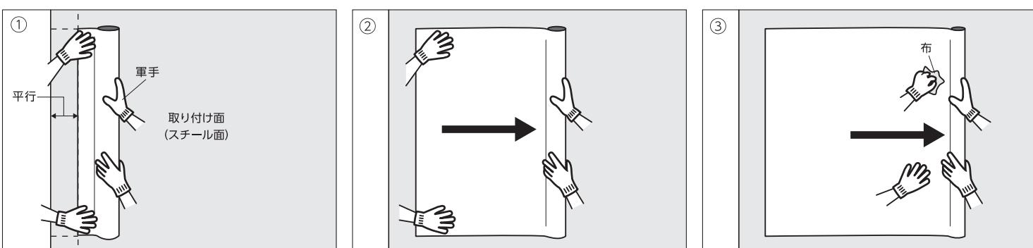
取り付け面と平行になるように取り付け位置をセットし、しっかりと取り付けてください。
